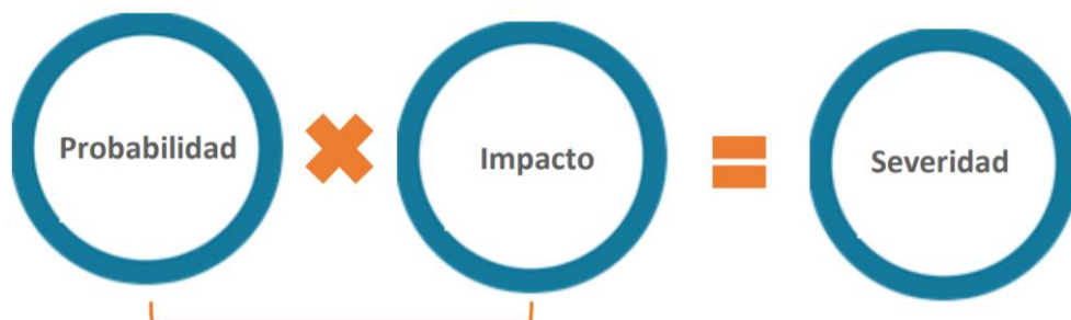
Ilustración 10 Determinación del Nivel de Riesgo
