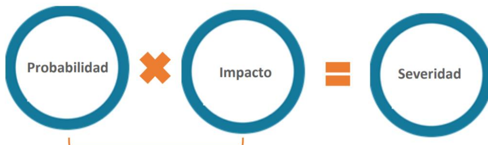
Ilustración 10 Determinación del Nivel de Riesgo
